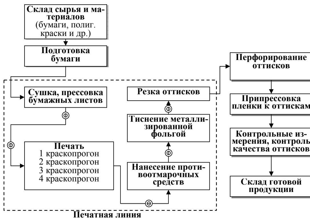
Рис. 2. Схема технологического процесса изготовления печатной продукции
